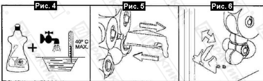
После этого вставьте все части, кроме передней крышки, в посудомоечную машину для мойки, либо промойте их под струей воды с мягким моющим средством. Зона отжима и передняя крышка должны быть очищены с помощью мягкой ткани и моющего средства, особенно тщательно вымывайте мякоть, и, если необходимо, используйте маленькую щетку для труднодоступных зон. После выполнения всех пунктов очистки соберите детали в обратном порядке. Будьте особенно внимательны и осторожны при выполнении следующих операций:
